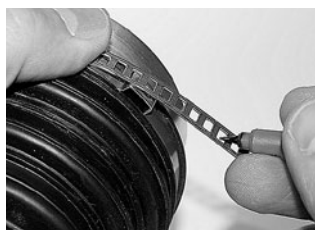
Étape 2 Définir la longueur du collier. S'assurer que l'extrémité de la bande dépasse l'oreille, comme illustré.
