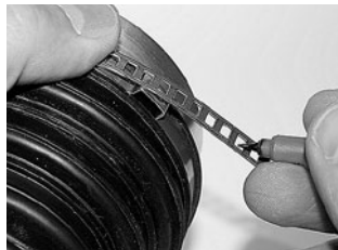
Schritt 2 Ermittlung der Klemmenlänge. Stellen Sie sicher, dass das Bandende wie dargestellt über das Klemmenohr hinaus ragt.
