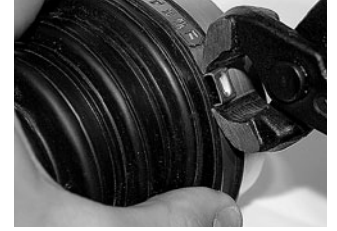
Schritt 4 Klemme über Objekt positio- nieren. Verschluss in kleinst- mögliche Position einhängen. Klemmenohr mit Oetiker Zange richtig schliessen.
